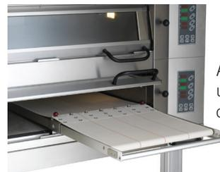
Absetzer für eine schnelle und effektive Beschickung des Ofens.
