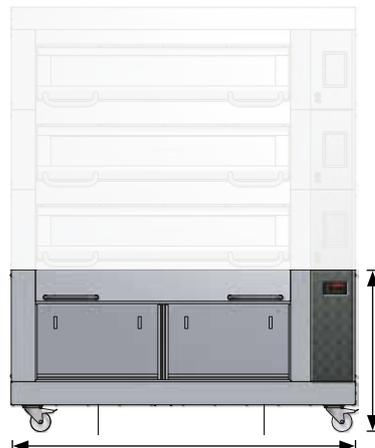
Die Höhe des Gärschrankes ohne Bodenplatte und Räder ist 560/740 mm. Inklusive Bodenplatte und Rädern sind die Abmessungen 810/990 mm.
